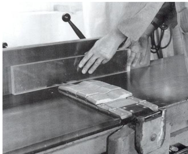
**Рисунок 36 - Сглаживание торца на продольно -
