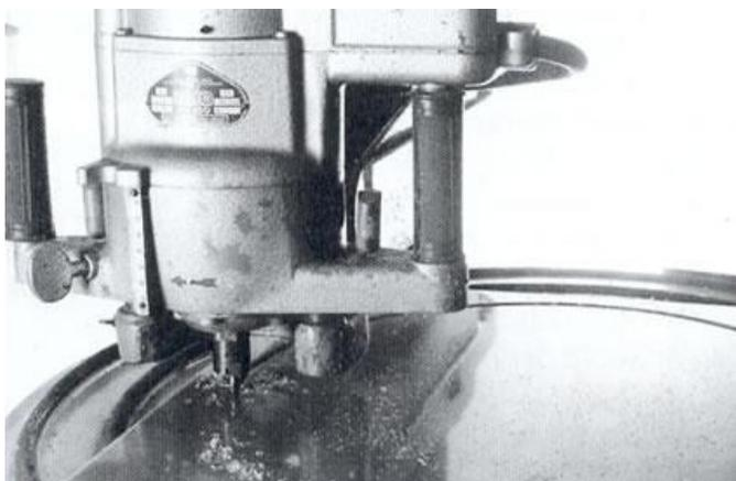
Рисунок 18 - Торцевая фреза
