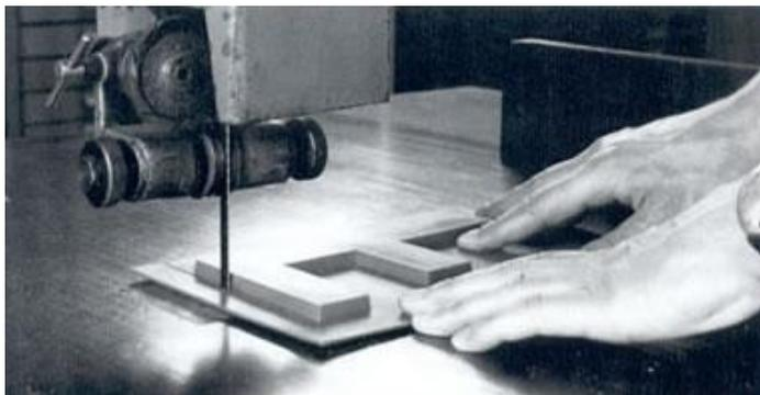
Рисунок 7 – Обрезка края при помощи ленточной пилы
