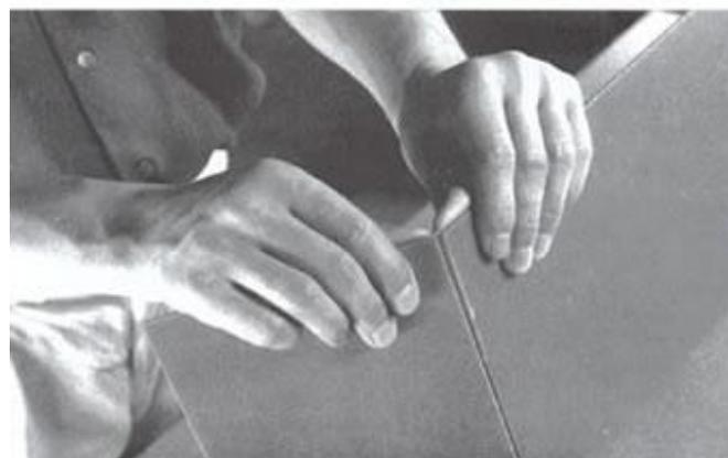
Рисунок 11 - Нанесение бороздки и поломка
